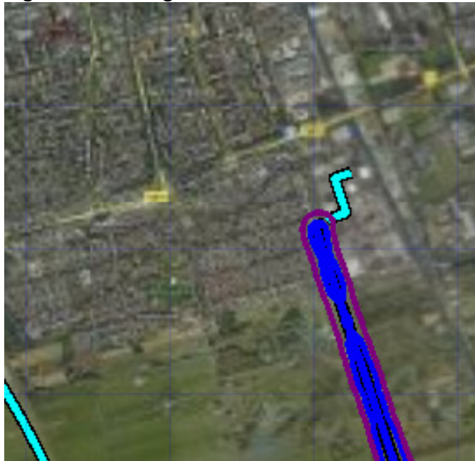
Figuur 1.9 Plaatsgebonden risico voor W-521-02 van N.V. Nederlandse Gasunie
