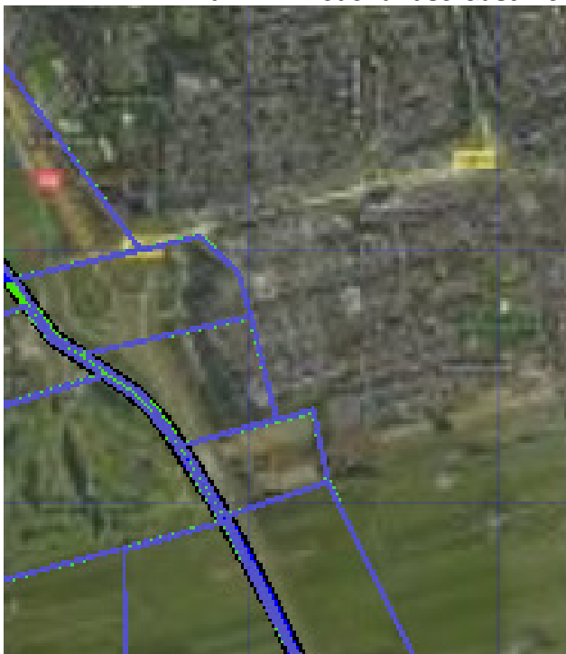
Figuur 1.6 Kilometer leiding behorende bij de maximale overschrijding van de FN-curve voor A-517 van N.V. Nederlandse Gasunie
