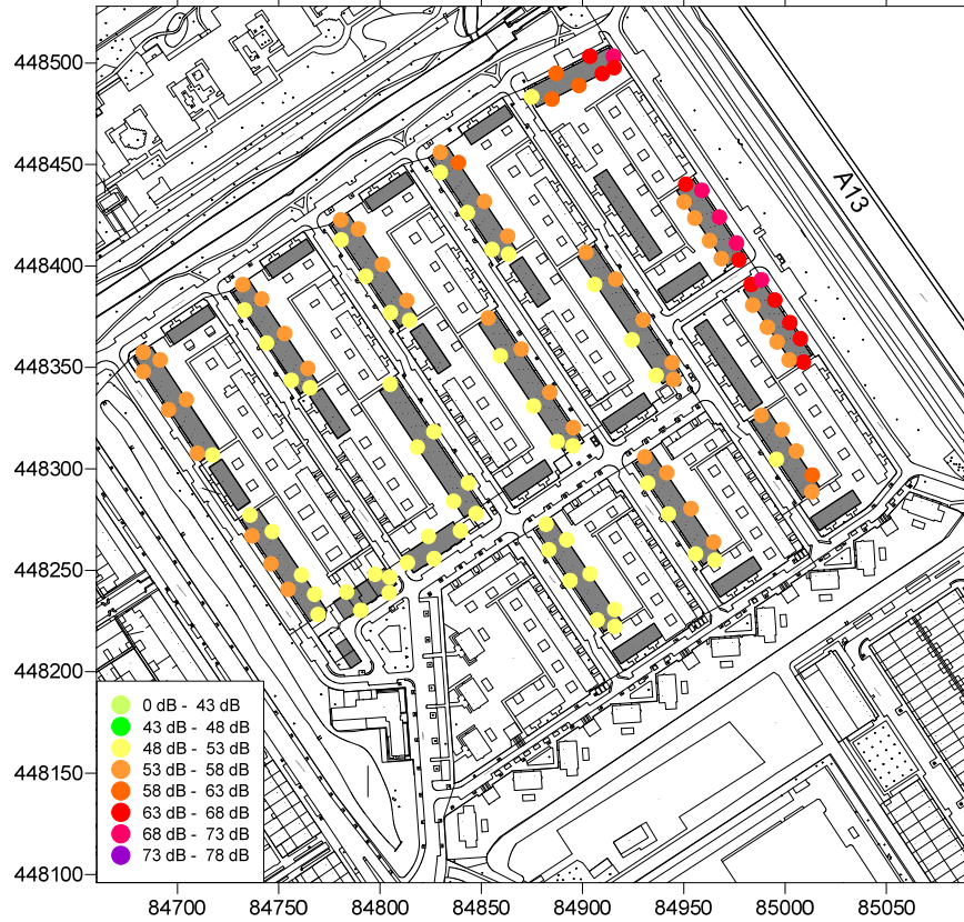
Figuur 11. Gevelbelasting van de (vervangende) nieuwbouw na planrealisatie – vanaf 3 e woonlaag
