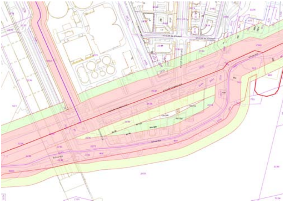
Figuur 3: Waterkeringen en bijbehorende beschermingszone
