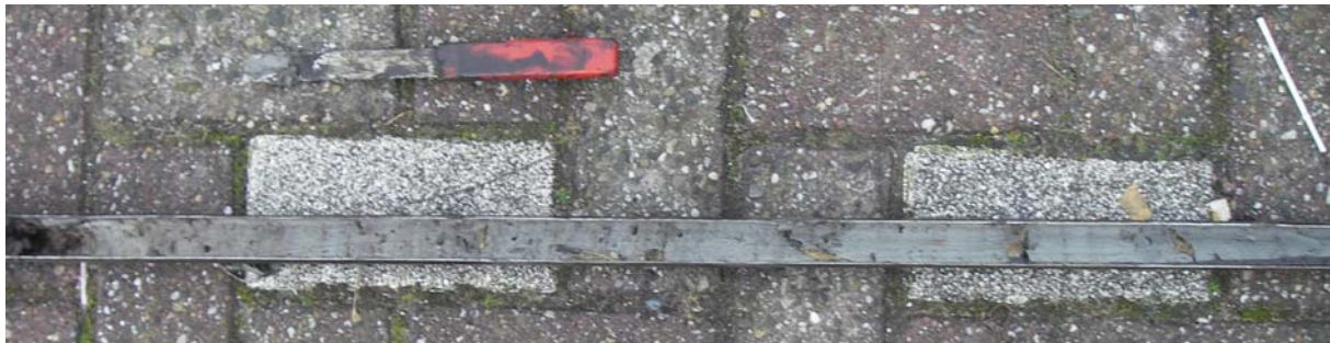
Figuur 13: De klei onder in boring 2
