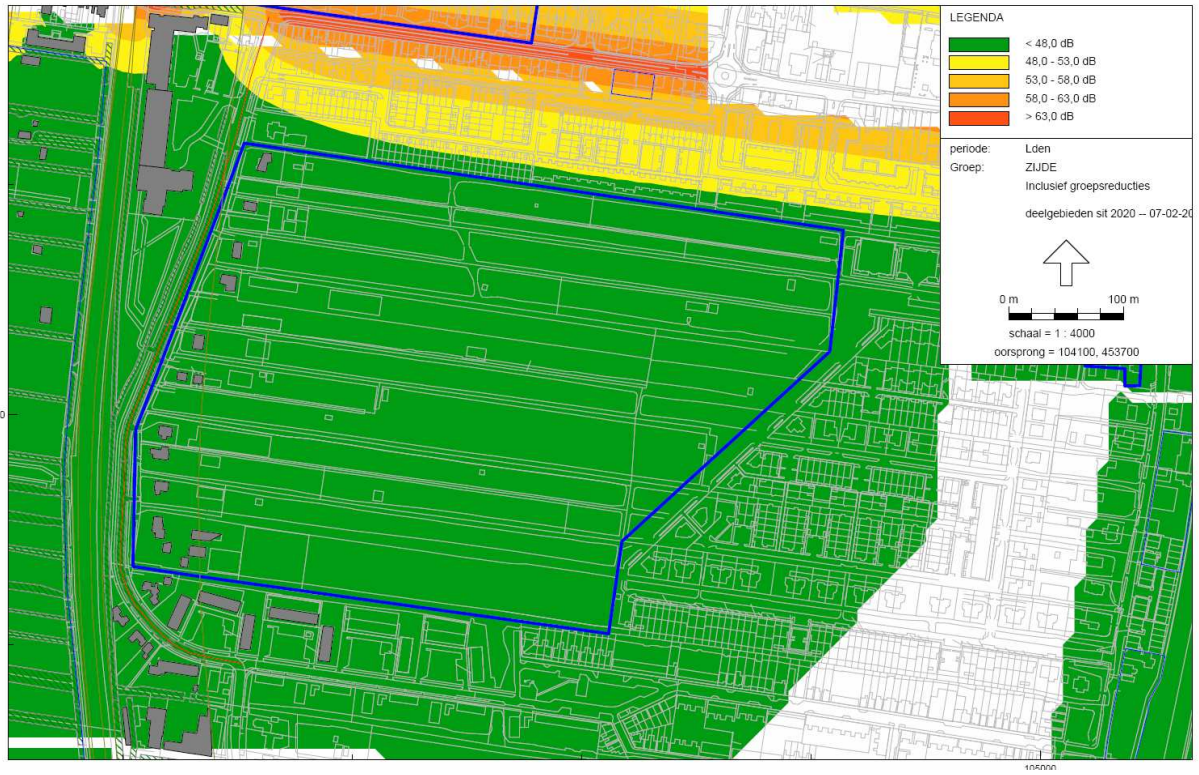
Figuur IV-1: geluidsbelasting vanwege Zijde
