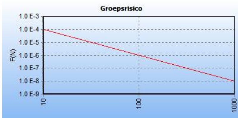
5.3 Figuur 5.3 FN curve voor 5440_leiding-W-573-09-deel-1 van N.V. Nederlandse Gasunie voor de kilometer tussen stationing 1280.00 en stationing 2280.00
