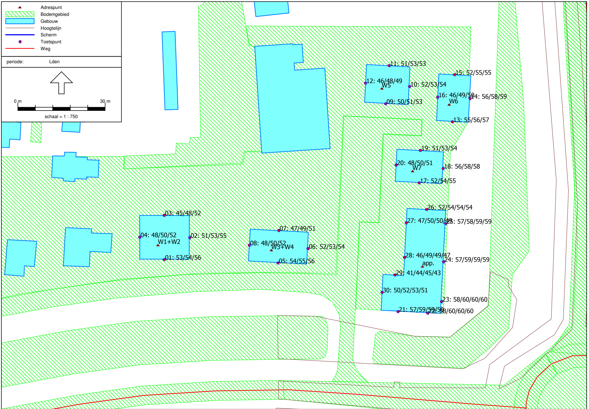
12.437 figuur 5, gecumuleerde geluidbelasting alle wegen, excl. aftrek art. 110g Wvgn Voortman Ingenieurs - bouwfysica & akoestiek
