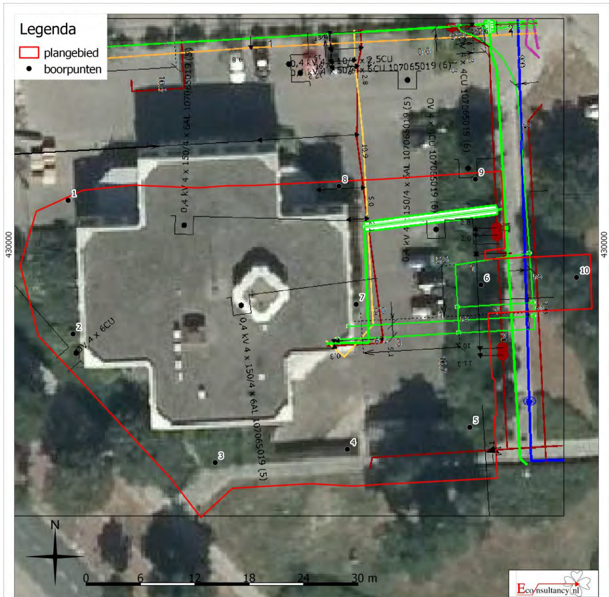
Figuur 4. Geplande boringen volgens PvA, met ligging kabels en leidingen
