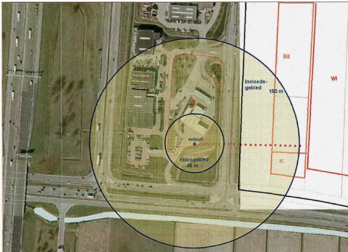
Figuur 4.1. PR 10^{-6} contour (45 m) en invloedsgebied groepsrisico (150 m) van LPG tankstation Ziedewij. (bron: DCMR, plan Lagewei-Vrouwenpolder Barendrecht, advies over het aspect externe veiligheid, oktober 2009)
