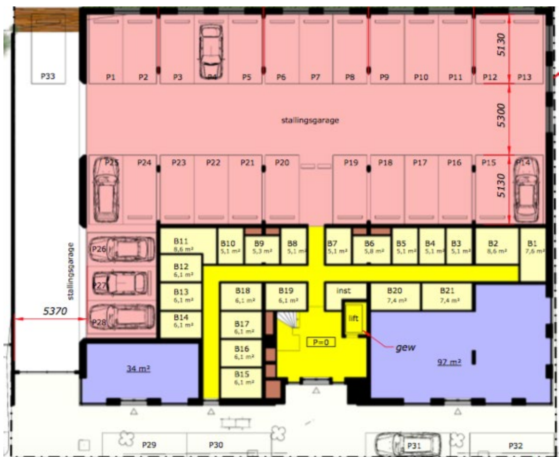
Fig. 6.1 Plattegrond met ingetekende parkeerplaatsen
