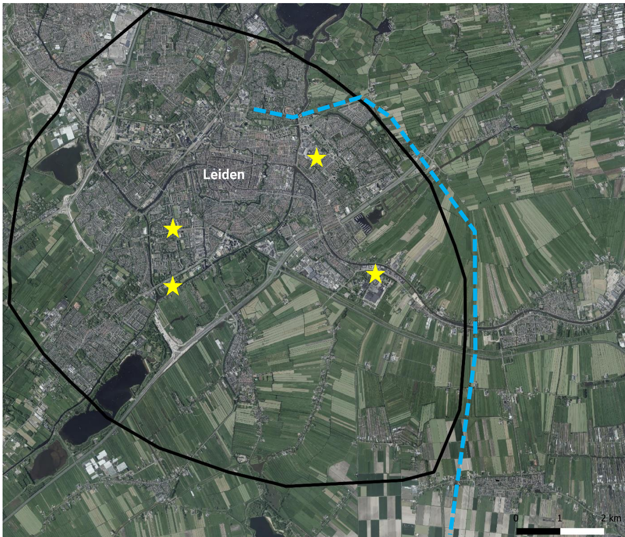
Afbeelding 4.1: Zoekgebied voor het 150/50kV-transformatorstation (zwarte kader), de 150kV-hoogspanningsverbinding Leiden-Zoetermeer (blauwe lijn) van TenneT en de 50/10kV-onderstations van Liander (gele sterren).
