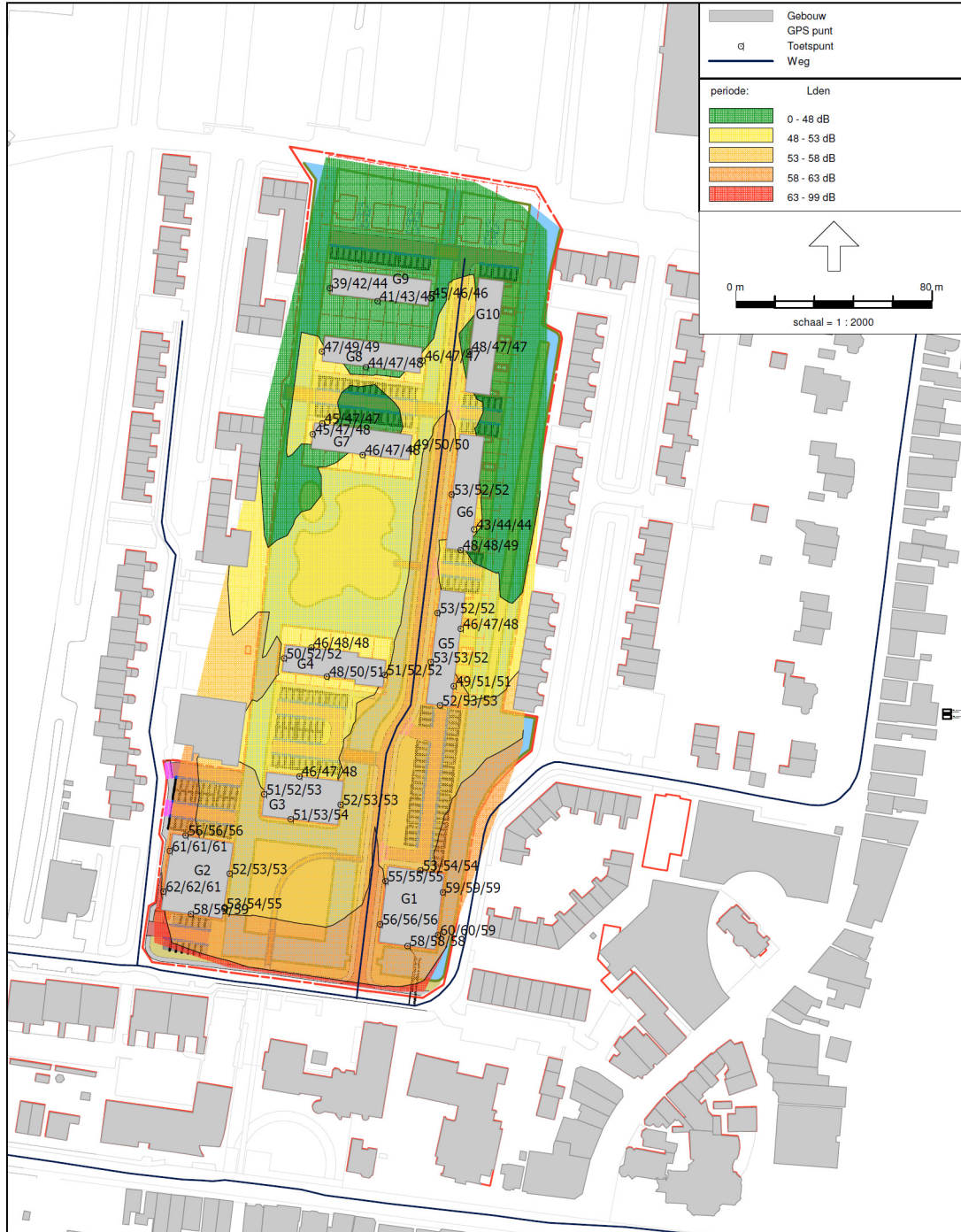
Figuur 5: Gecumuleerde geluidsbelasting t.g.v. alle beschouwde wegen excl. aftrek art. 110g Wgh
