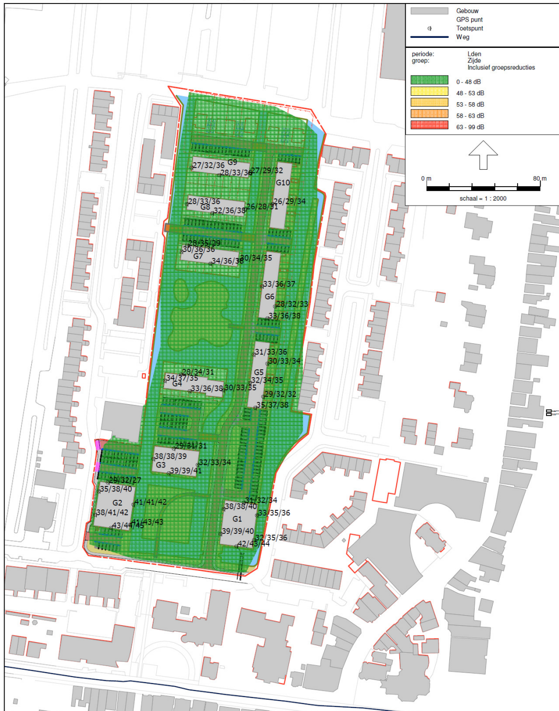
Figuur 1: Geluidsbelasting t.g.v. de Zijde, incl. aftrek art. 110g Wgh
