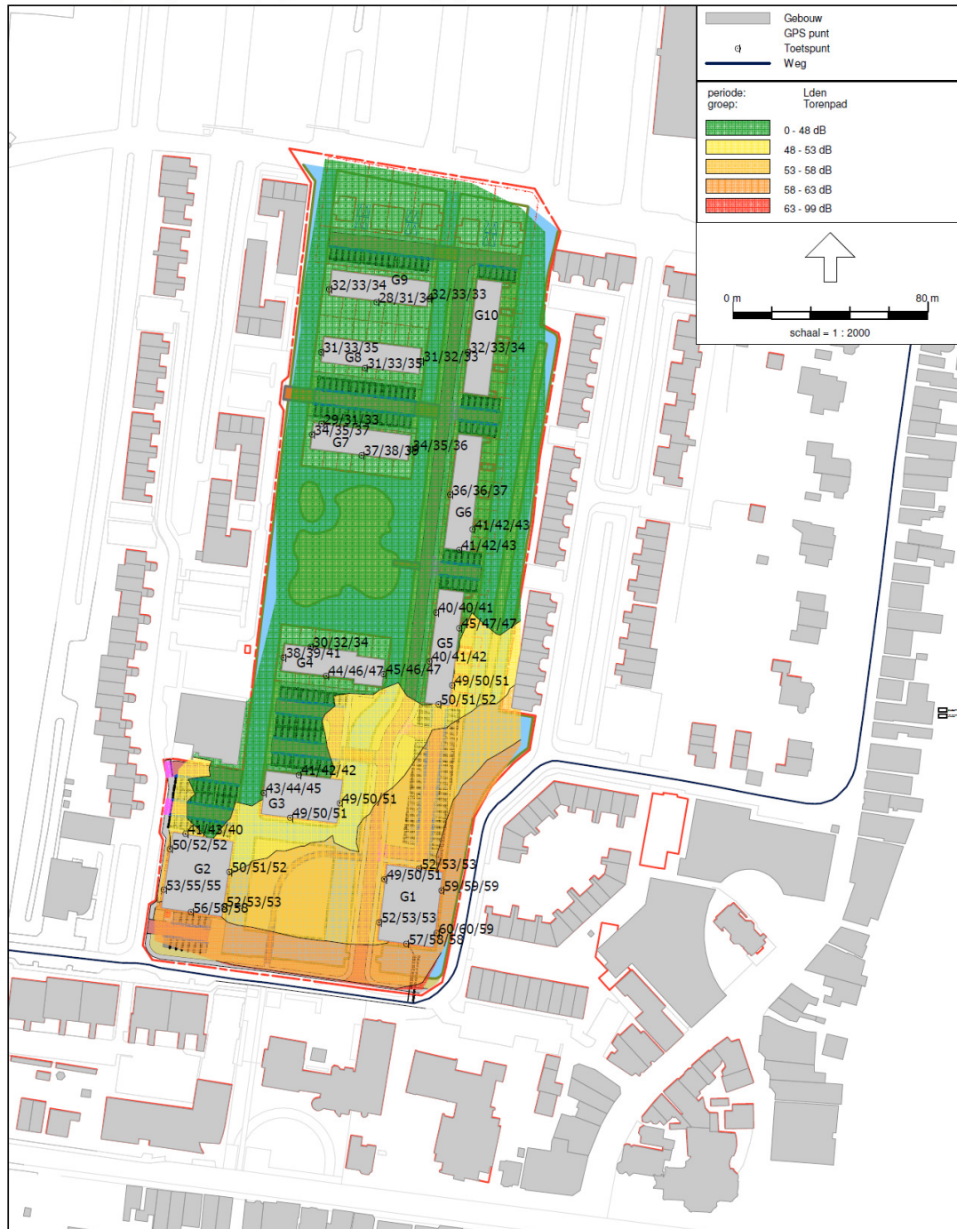
Geluidsbelasting Lden tgv het Torenpad, excl. aftrek art. 110g Wgh
