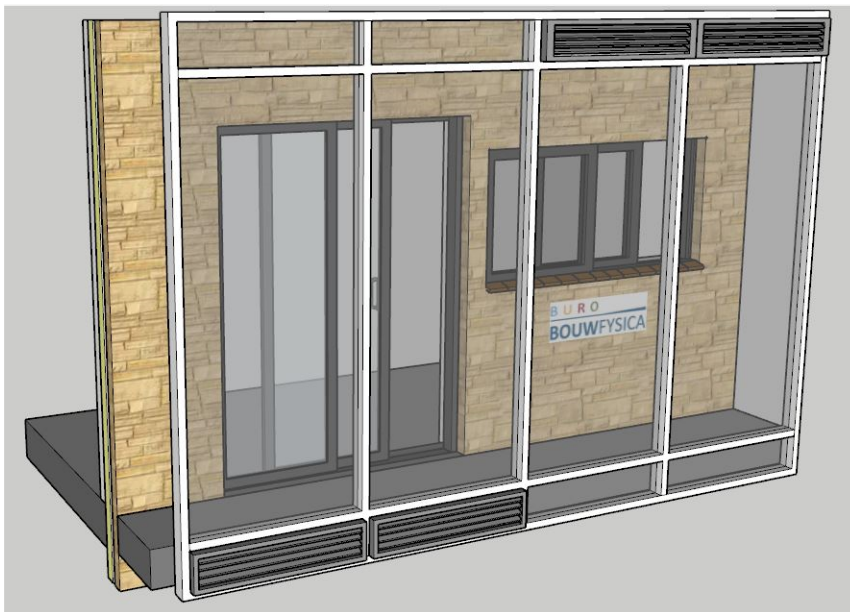
Figuur 7 het principe van een vliesgevel.
