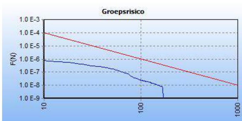
5.5 Figuur 5.5 FN curve voor 7116_leiding-W-571-07-deel-1 van N.V. Nederlandse Gasunie voor de kilometer tussen stationing 0.00 en stationing 430.00
