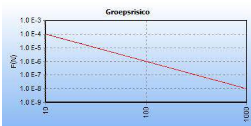
5.5 Figuur 5.5 FN curve voor 7116_leiding-W-571-07-deel-1 van N.V. Nederlandse Gasunie voor de kilometer tussen stationing 0.00 en stationing 430.00
