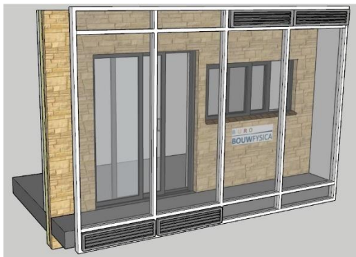
Figuur 4 Het principe van een vliesgevel.
