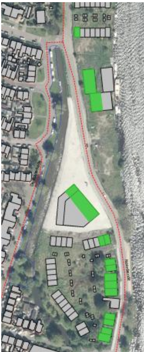
Figuur 4.3 Woningen waarbij de ten hoogste toelaatbare geluidsbelasting wordt overschreden ten gevolge van verkeer op het Noordeinde
