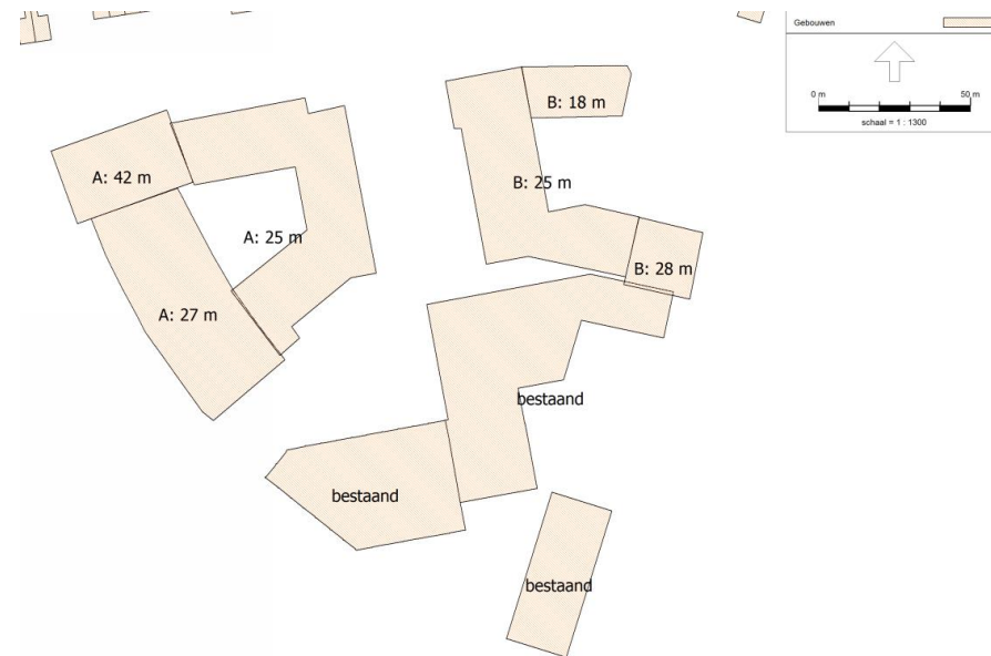
Figuur 3b: Bouwvlakgrenzen fase 1 met max. bouwhoogte
