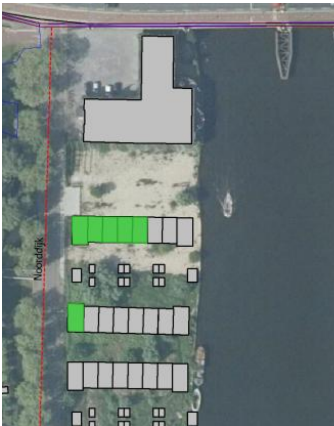
Figuur 4.4 Woningen waarbij de berekende ten hoogste toelaatbare geluidsbelasting wordt overschreden ten gevolge van het industrieterrein Wessanen
