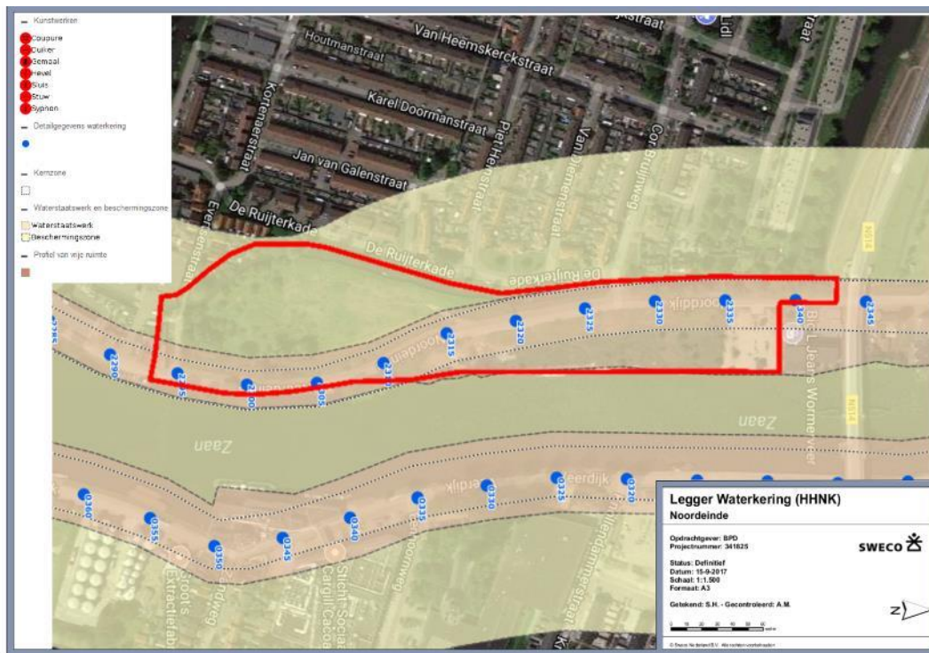
Figuur 2.3: Zonerings regionale waterkering t.p.v. weg Noordeinde/ Noorddijk (Bron: Legger Water HNK)
