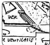
Het dek wordt op een aantal plekken open gewerkt ten behoeve van ventilatie (gat in het dek en trappen richting de Zaan)
