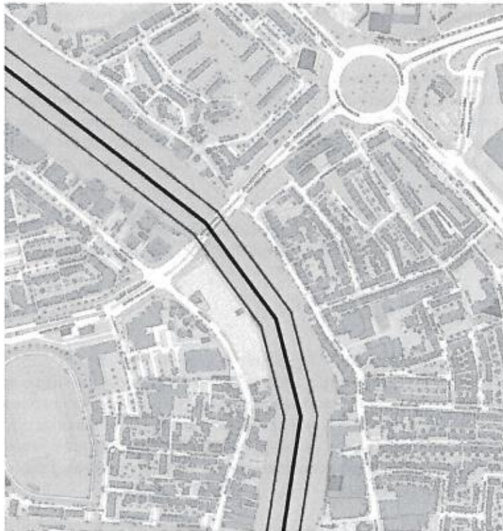
Figuur 3: vaarwegprofiel (diepgang 2,85 m; blauw, diepgang 1,60 m geel) locatie Westzijde 276
