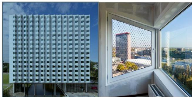
Figuur 8 Zaagtandgevel bij een geluidsbelasting van de zijkant.
