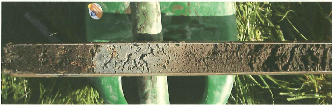
Figuur 4: Wervershoof, Dirk Bijvoetweg: boring 3, 160 tot 200 centimeter beneden maaiveld. Links op de foto het donkerbruine veen. Hierop is erosief het grijze kleig zand afgezet. Vervolgens ontstond in het gebied een meer waarin het donkerbruine gyttja rechts op de foto is afgezet.
