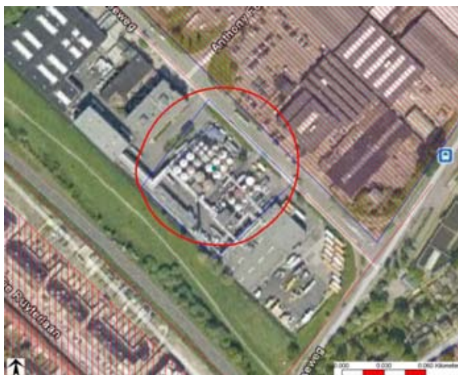
Figuur 3.1.2a: Plaatsgebonden risico tankpark Quaker Chemical
