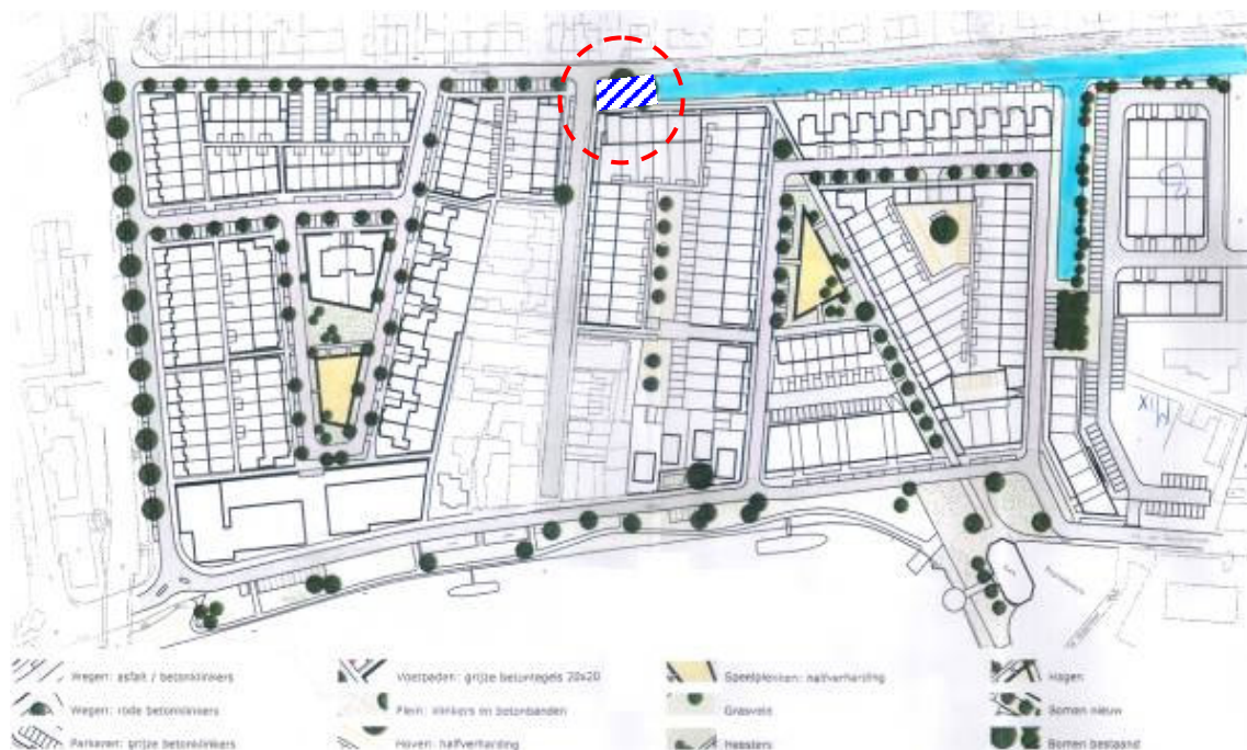
Figuur 9 Ruimte voor extra functioneel open water in verkavelingplan ontwikkellocatie Vinckebuurt te Uithoorn
