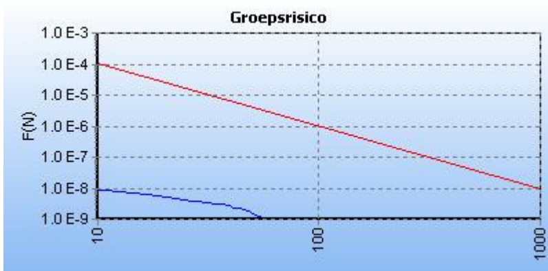
Figuur 5.2 FN curve voor A-551 van N.V. Nederlandse Gasunie voor de kilometer tussen stationing 46070.00 en stationing 47070.00
