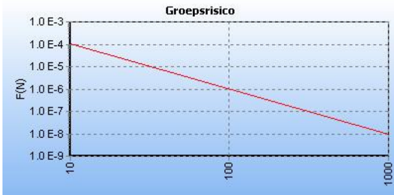
Figuur 5.4 FN curve voor A-566 van N.V. Nederlandse Gasunie voor de kilometer tussen stationing 40300.00 en stationing 41300.00
