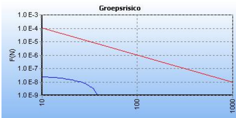
Figuur 5.5 FN curve voor A-620 van N.V. Nederlandse Gasunie voor de kilometer tussen stationing 7670.00 en stationing 8670.00
