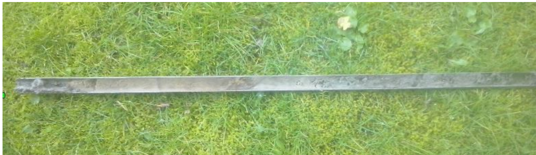
Figuur 7. Oosterend, Texel, Botterstraat. Het pakket zwak gelaagde, sterk zandige klei dat op alle boorpunten boven het dekzand is aangetroffen. Links is de onderkant van de boring.
