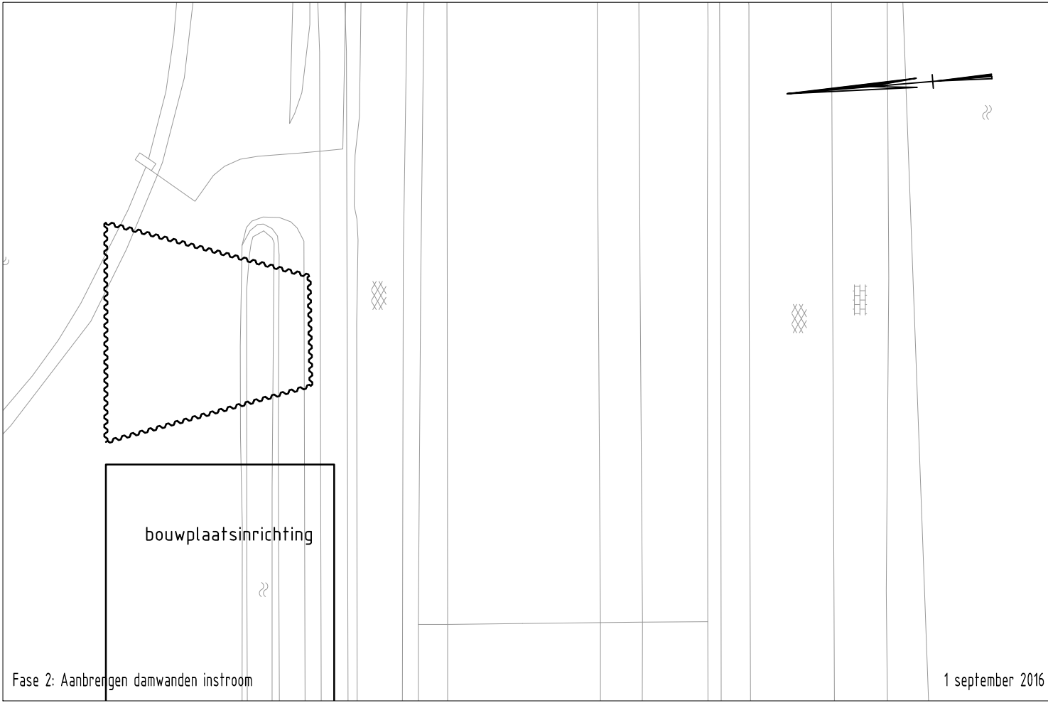
Fase 2: Aanbrengen damwanden instroom 1 september 2016
