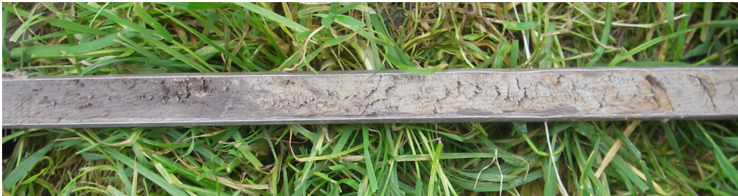
Figuur 6. Dirkshorn, Oosterdijk. De abrupte overgang tussen de toplaag van humusrijke klei (links) en de gelaagde getijden-afzettingen (rechts).
