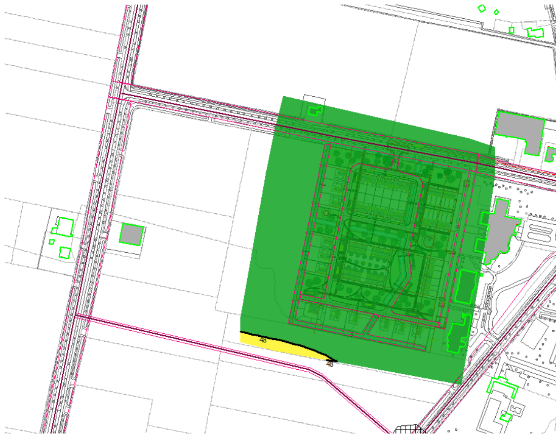
Figuur 4-2 Toetsingswaarde van de geluidsbelasting op hoogte 4,5 meter boven maaiveld, ten gevolge van wegverkeer op de Harenkarspelweg, L_{den} in dB
