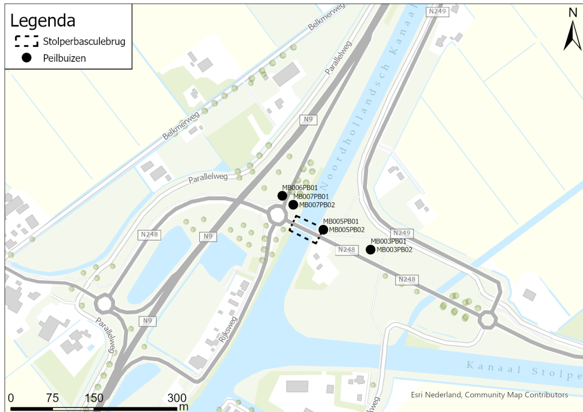
Afbeelding 3.4 Locaties van de geplaatste peilbuizen
