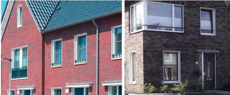
Detailering ramen. Kenmerkende verticaliteit. Variatie in borstwering en kozijnaanzicht.
