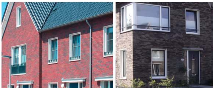
Detailtering ramen. Kenmerkende verticaliteit. Variatie in borstwering en kozijnaanzicht.
