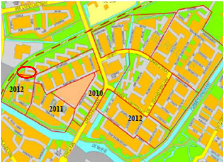
Figuur 3: Vervanging van het gescheiden rioolstelsel bij het project Groot Onderhoud Wheermolen-West (Verbreed Gemeentelijk Rioleringsplan Purmerend 2013-2017).
