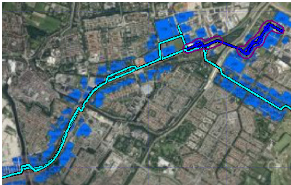
Afbeelding 18. Plaatsgebonden risico per jaar leiding W-570-26
