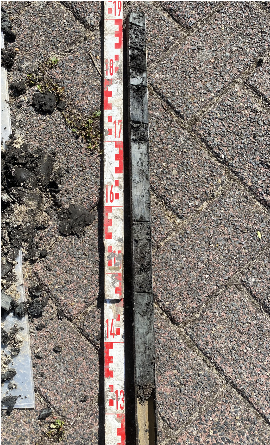
Afbeelding 3: Een doorsnede van boring 3 verricht met een gutsboor op 1,9 meter diepte. Een kolom opgeboorde grond van 1,3 tot 1,9 meter diepte. Zichtbaar zijn de vele laagjes veen en klei dat wijst op een ophogingspakket.
