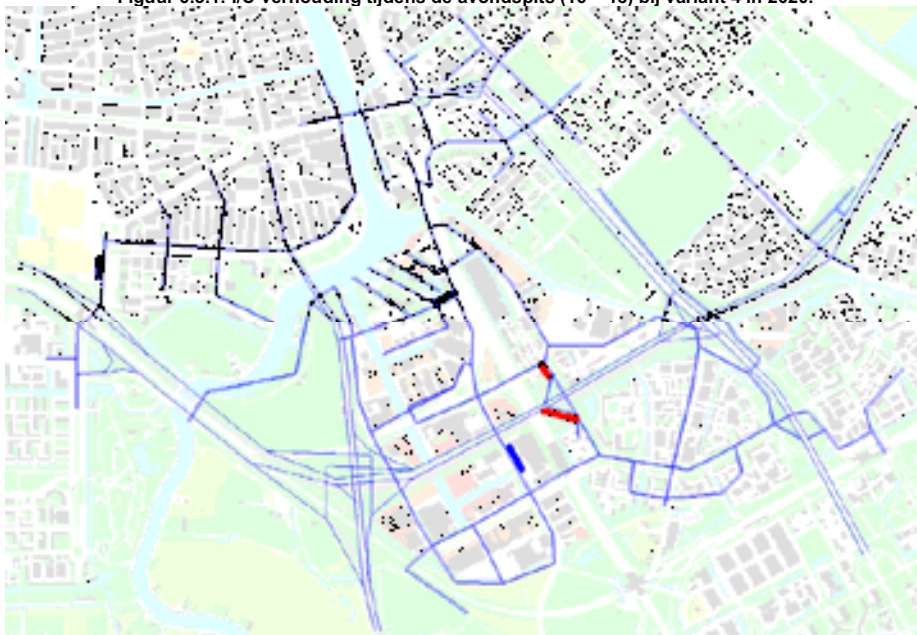
Figuur 6.3.2: Toe- en afnames in de I/C-verhouding tijdens de avondspits (16 – 18) bij variant 4 in 2020.
