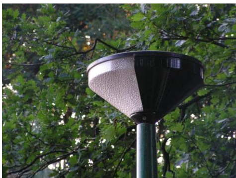
Figuur 8: Een aangepaste armatuur (vergelijkbaar met figuur 7, Lightronics, type Bart) waarvan de helft is afgeschermd om uitstraling naar een vaart te voorkomen.
