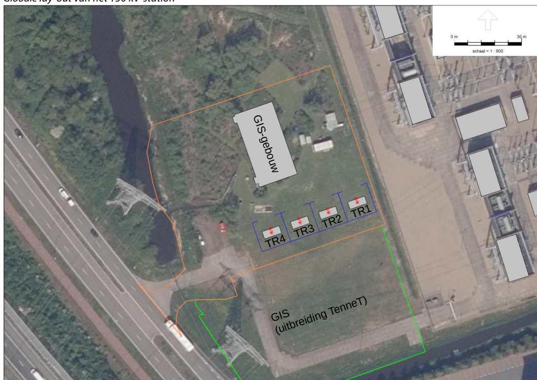
f2.2 Globale lay-out van het 150 kV-station
