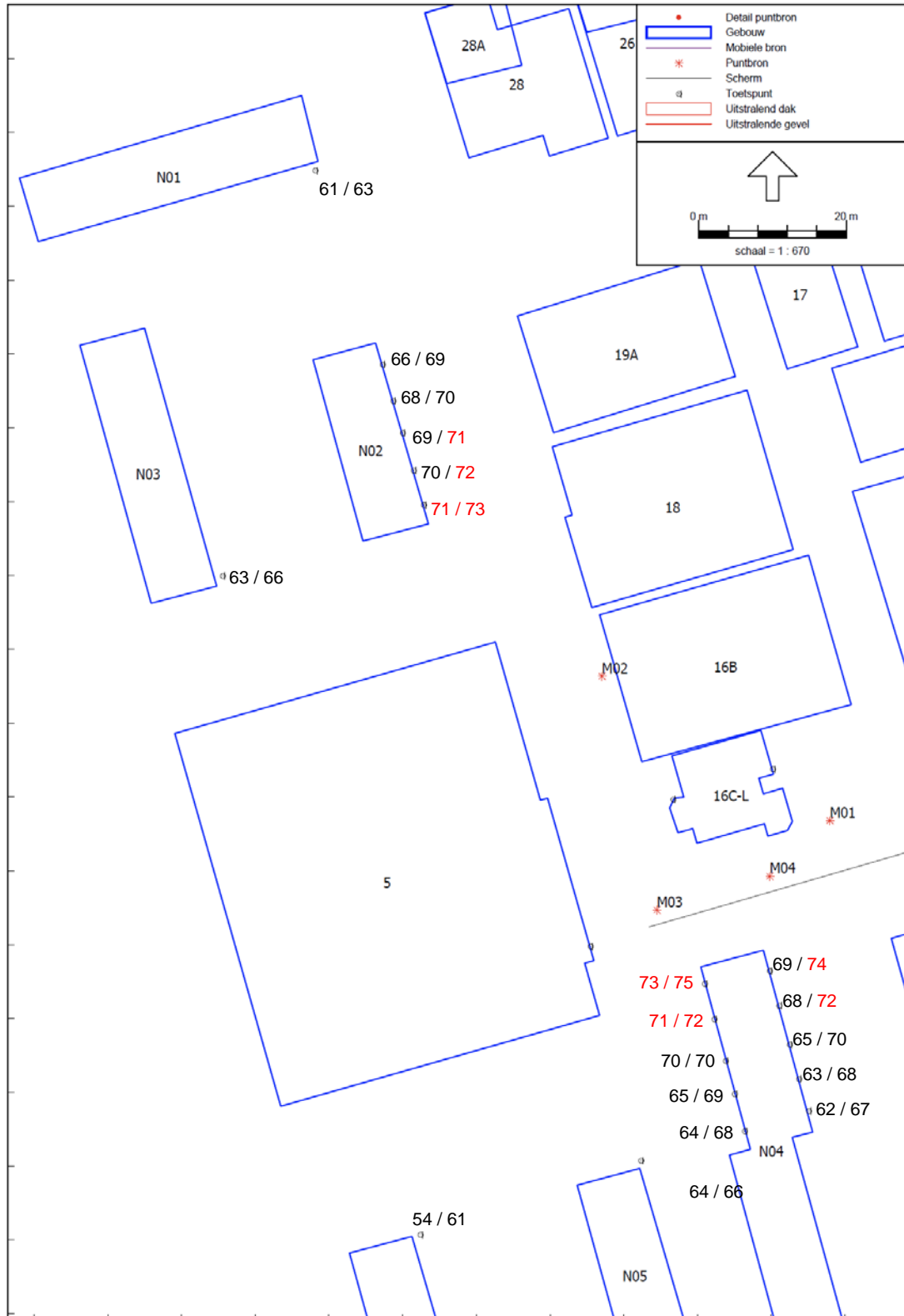
Afbeelding 5.2 | Resultaten maximale geluidniveaus op nieuwbouw met scherm langs bedrijf
