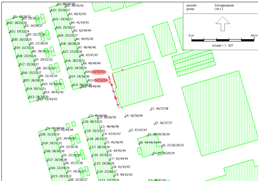
Figuur 4-4 Overzicht berekent L_{Ar,LT} , in dB(A), op de gevels van de omliggende woningen
