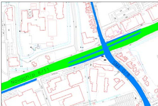
Figuur 3.2: Overzicht asfaltverharding Provincialeweg
