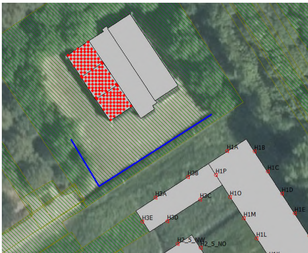
Afbeelding 5.2: Optie B scherm van 13 meter hoogte
