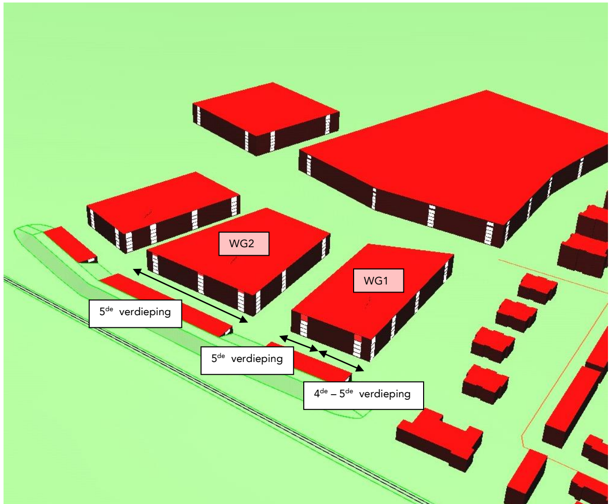
Posities dove gevels bij WG1 en WG2 als gevolg van overschrijden maximum grenswaarde spoortraject
