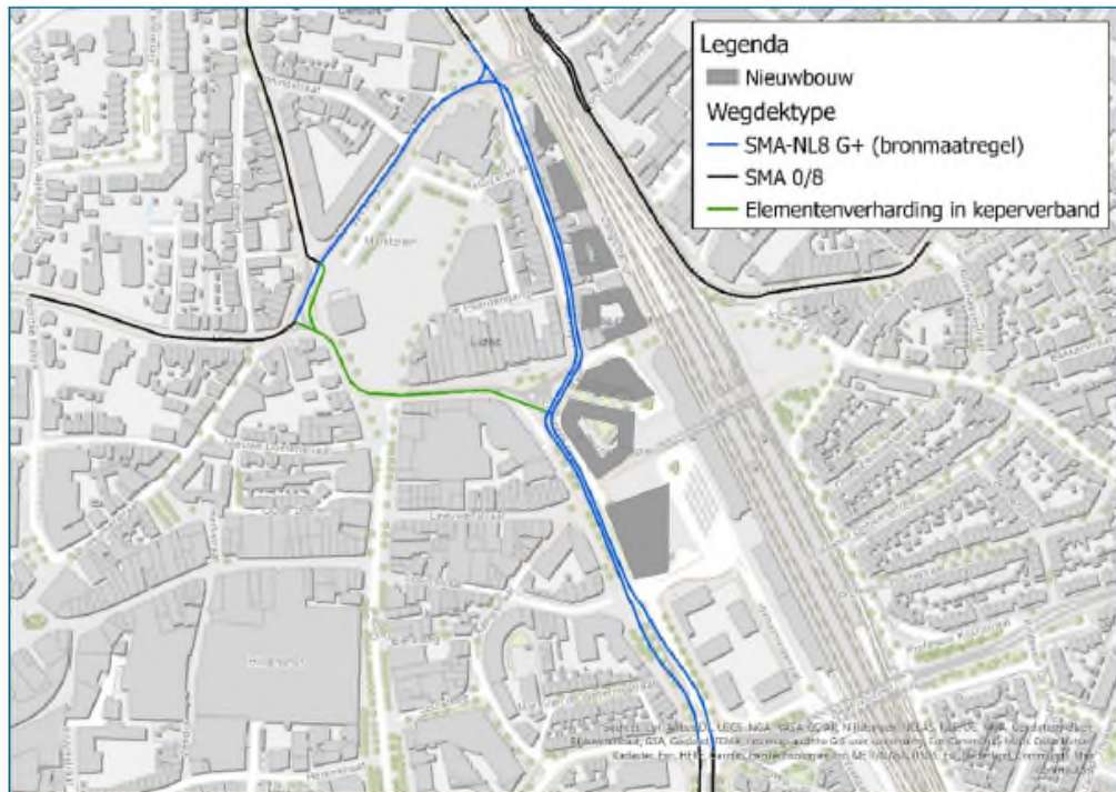
Figuur 3.2: Wegvakken te voorzien van een geluid reducerende wegdekverharding van het type SMA-NL8 G+ (blauwe wegvakken)
