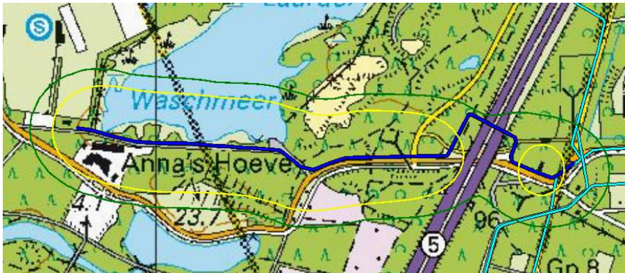
figuur 5.6 plaatsgebonden risico buisleiding W500-04
