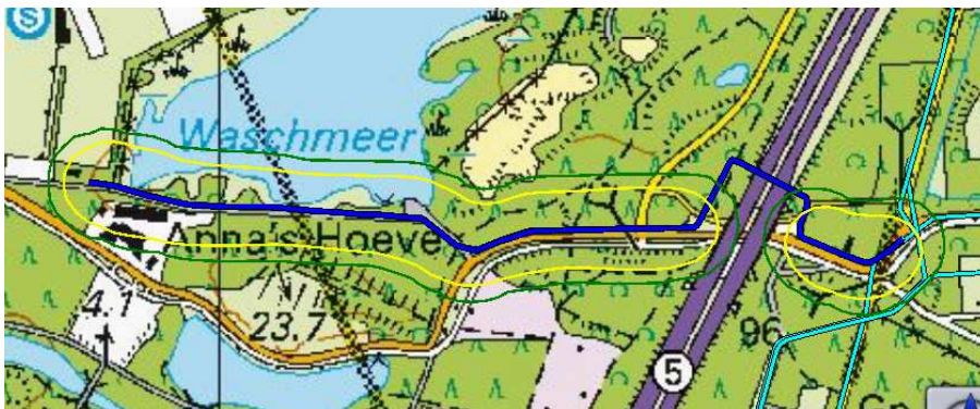
figuur 5.7 plaatsgebonden risico buisleiding W500-03
