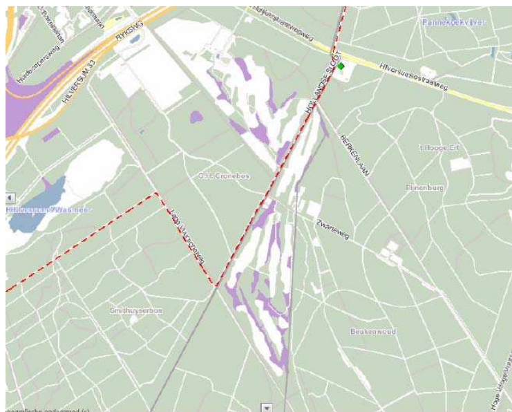
figuur5.2 Globale indicatie van vluchtroutes in de omgeving van de hogedruk aardgasleiding (rode stippellijn) voor locatie 2 (bron: risicokaart, Kadaster)
