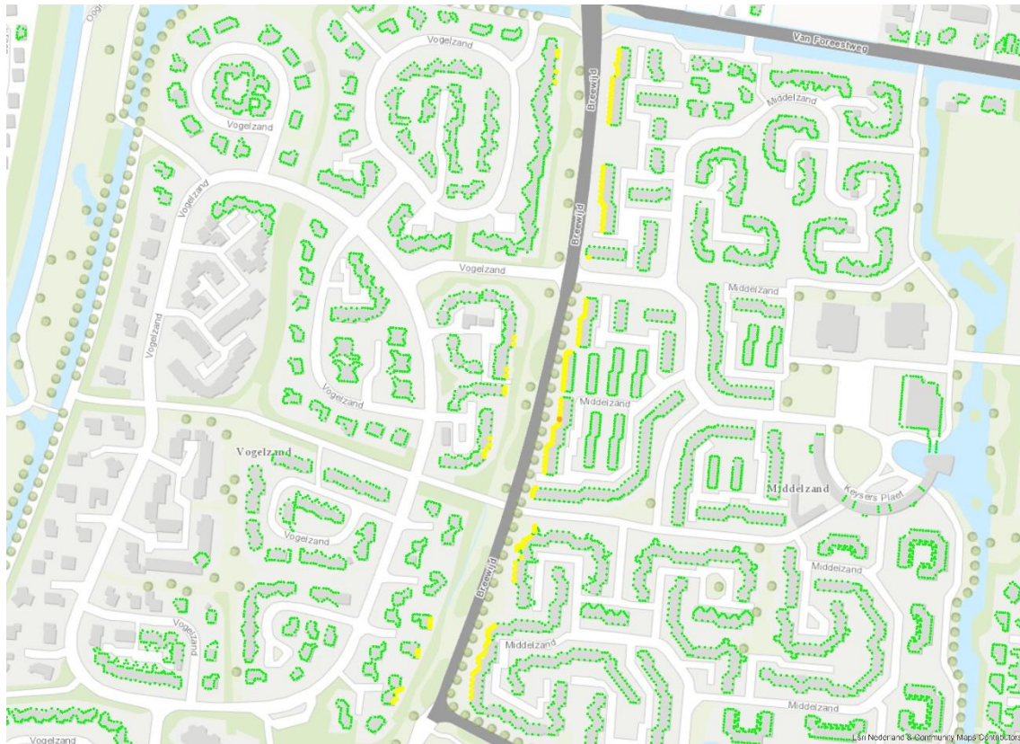
Figuur: visuele weergave van woningen die een verhoging van de geluidbealsting ondervinden vanwege de Breewijd (Dubofalt) na uitvoering van het plan en het verschuiven van de Breewijd (oranje = toename 1,5 – 3,0 dB, geel = toename 3,0 – 4,5 dB)
