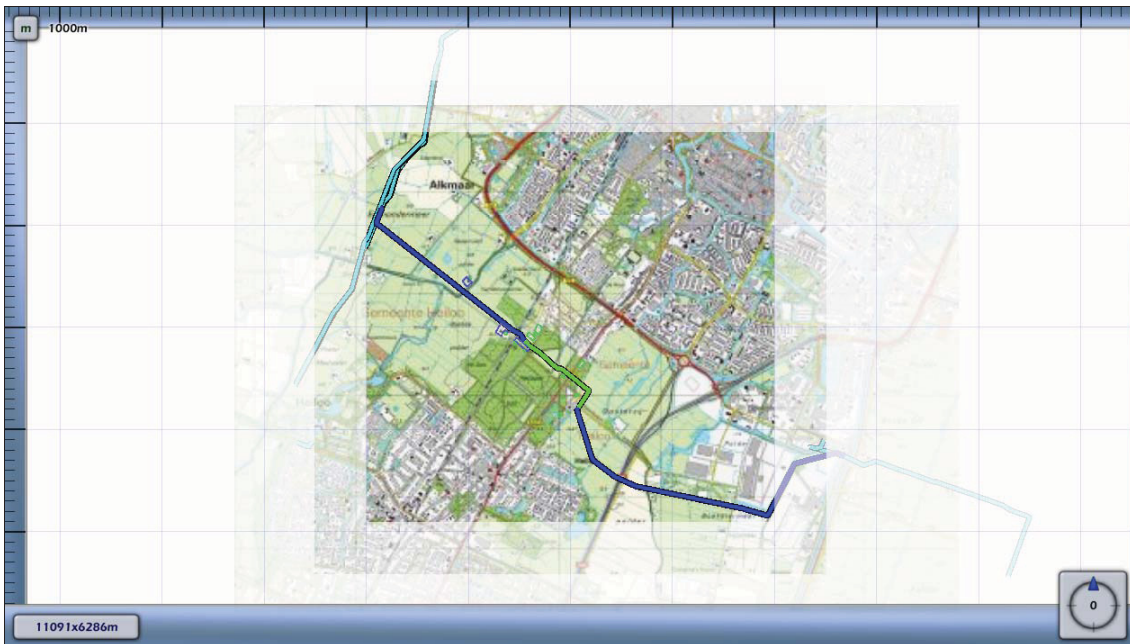
Figuur 4.2. Kilometer leiding behorende bij de maximale overschrijding van de FN-curve voor W-571-15 van N.V. Nederlandse Gasunie
