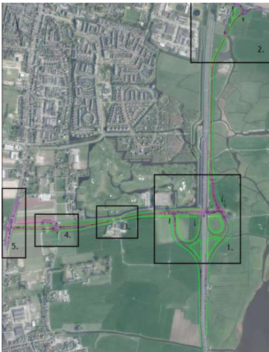
Figuur 3: Ontwerp aansluiting A9 (Arcadis, 2020), met daarin de volgende te realiseren wijzigingen: 1. Half klaverblad 2. Aansluiting Kanaalweg 3. Tracé bij Lagelaan 5/7 4. Kruising Oosterzijweg 5. Kruising Kennemerstraatweg
