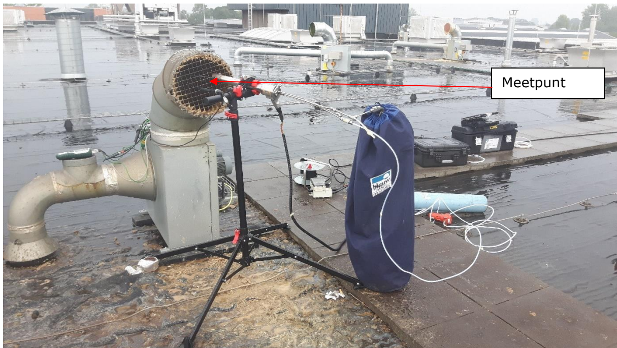
Figuur 2.3 Foto van de meetsituatie van de afzuiging van de maaktanks
