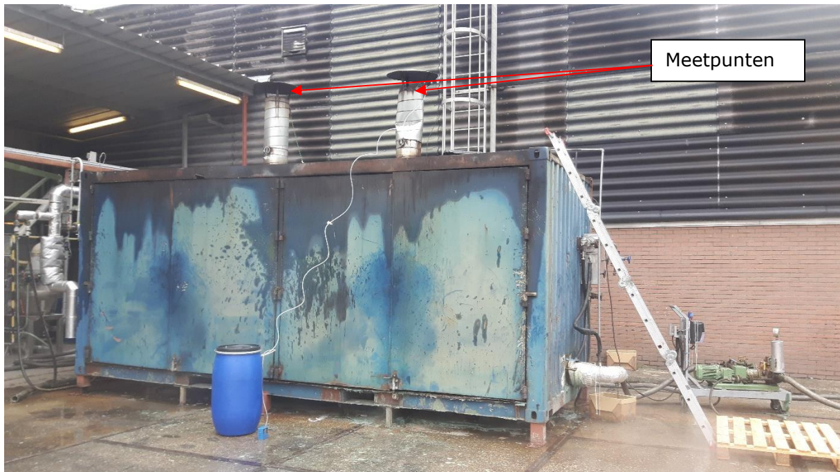
Figuur 2.2 Foto van de meetsituatie van de smeltoven
